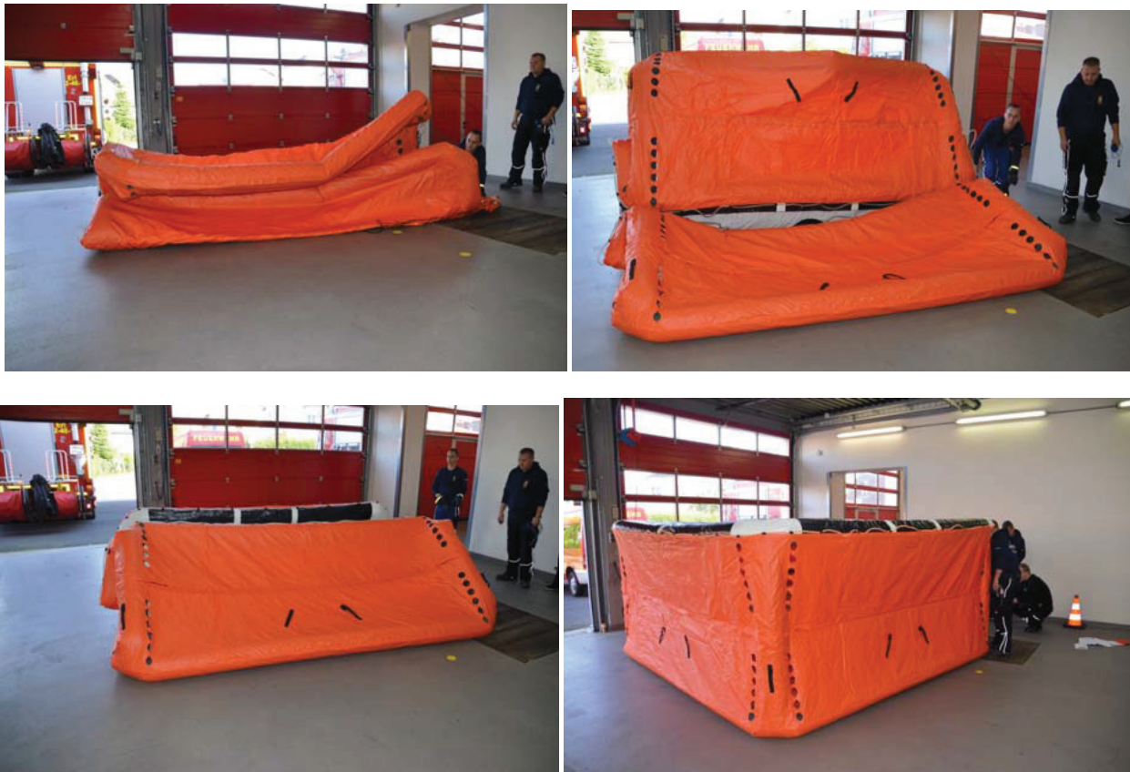
Stoppen der Zeit und Dichtigkeitsprüfung: Das Sprungpolster muss innerhalb von 30 Sekunden einsatzbereit sein
