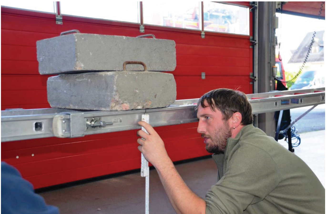
Gerätewart Torsten Paulus beim Belastungstest einer Steckleiter
