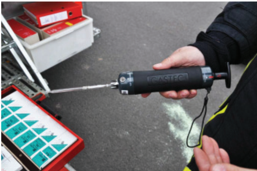
Handpumpe mit angesetztem Prüfröhrchen
