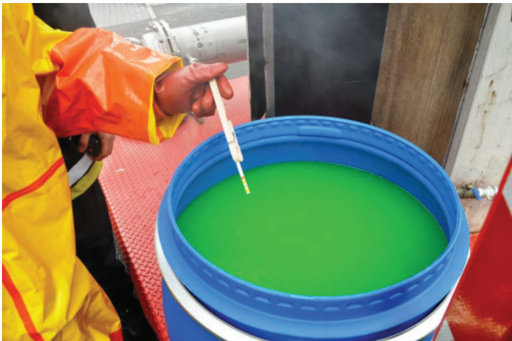
Die Verfärbung des pH-Papiers zeigt an, ob es sich um eine Säure oder Lauge handelt
