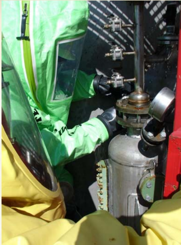
Arbeiten an einem defekten Absperrventil
