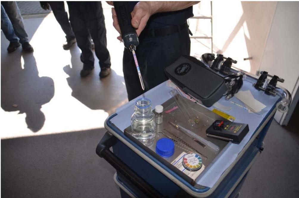
Gasprobenahme mit Handpumpe und Prüfröhrchen
