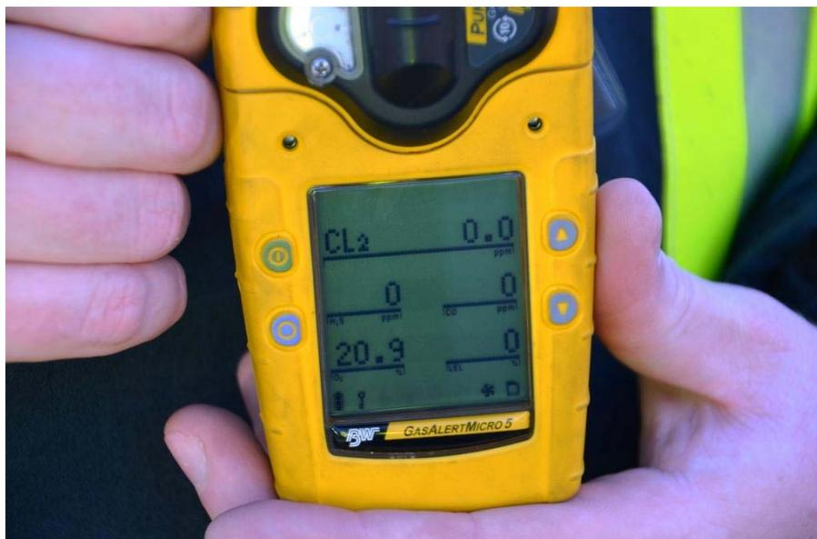
Cl<sub>2</sub>: 0,0 ppm - Das Gasmessgerät zeigt eine chlorgasfreie Außenluft an
