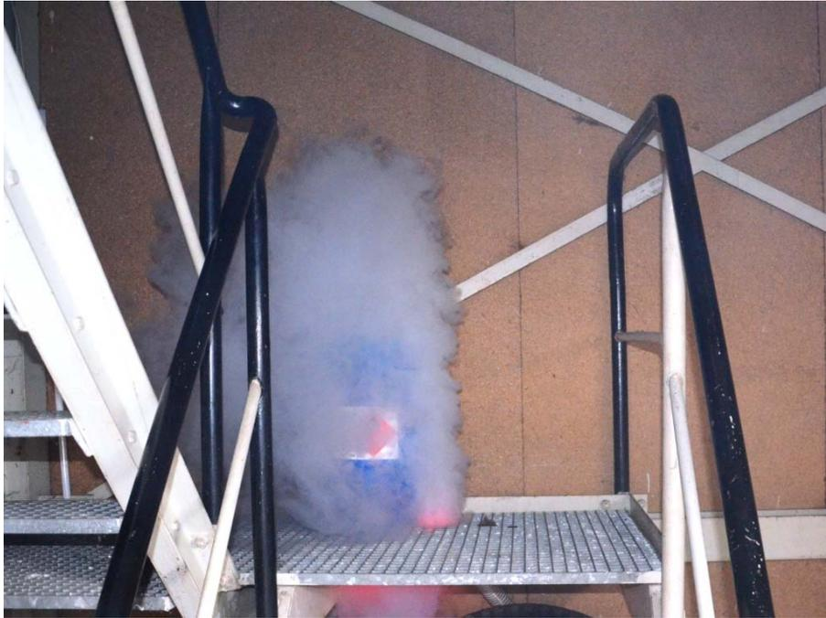
Die aus dem beschädigten Fass austretende konzentrierte Salzsäure reagiert mit dem Metall der Treppe
