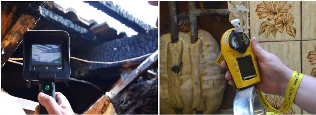
Überprüfung der Einsatzstelle mit Wärmebildkamera (links) und Gasmessgerät
