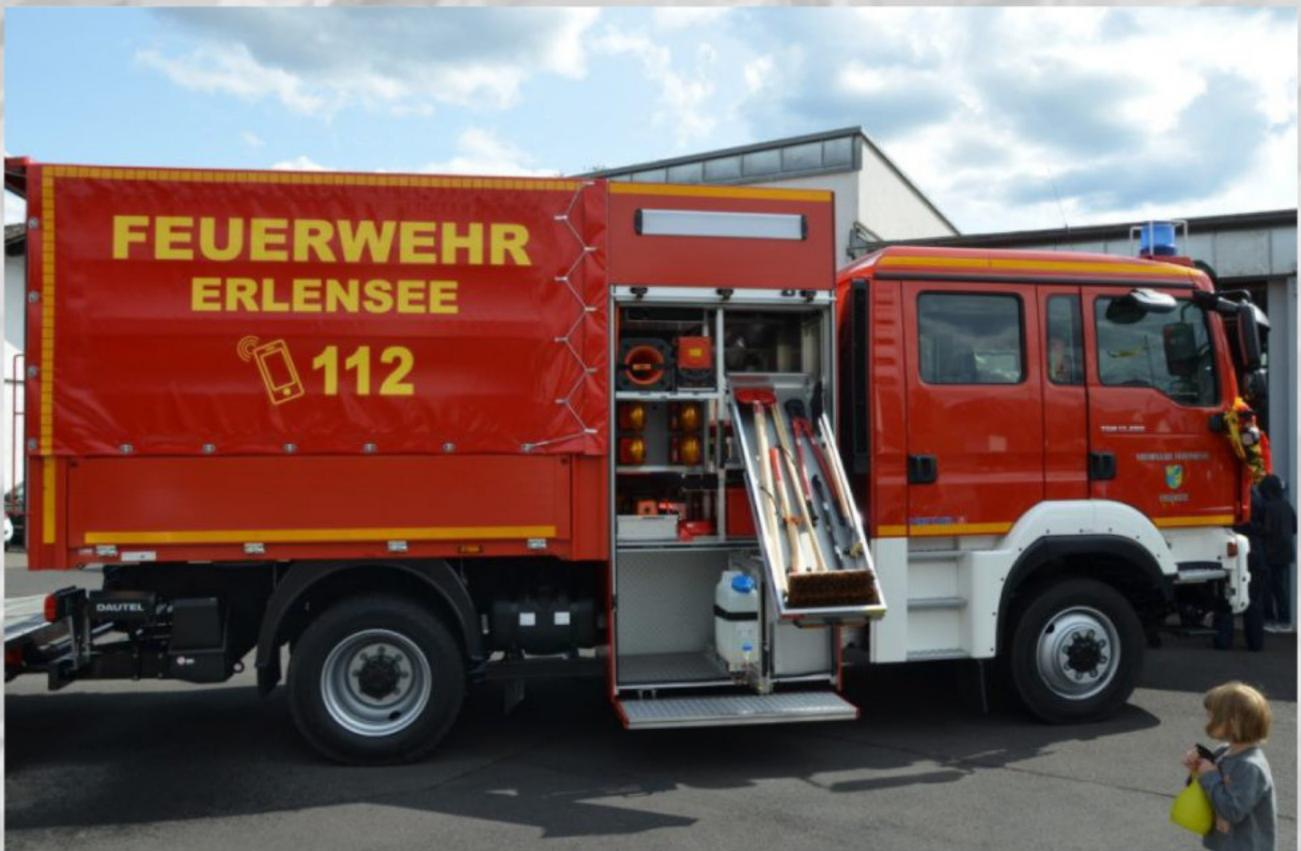
Das Fahrzeug hat ein zulässiges Gesamtgewicht von 16t, wobei hier 6 t Beladepazität eingerechnet ist. Es wird von einem 290 PS Euro 6-Dieselmotor mit Automatikgetriebe allradangetrieben.
