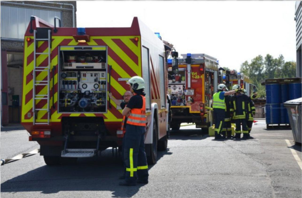
Im Einsatz waren außerdem drei Messfahrzeuge: einmal der GW-Mess der Feuerwehr Hanau und außerdem zwei Fahrzeuge der Feuerwehr Wächtersbach. Während Messfahrten wurden Luftproben zur weiteren Analyse auf Adsorptionsröhrchen gesammelt als auch direkte Analysen mittels Photoionisationsdetektoren vorgenommen.
